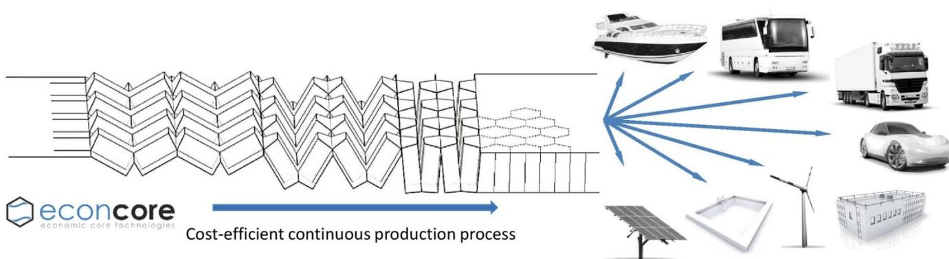
Дополнительное снижение затрат может быть предложено на завершающей стадии за счет возможной интеграции операций по последующей обработке (например, обработка коронированием, рилёвка, высокотемпературное формообразование и т. д.) с непрерывным процессом производства сэндвич-панелей сотовой структуры.
